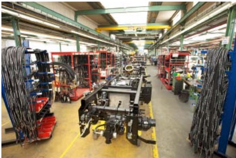
» In jeder Kompaktkehrmaschine von Bucher Schörling wird eine Vielzahl unterschiedlicher Hydraulikschläuche verbaut.
