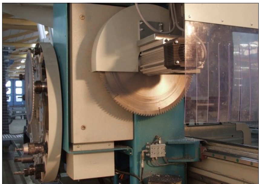
Zugsäge mit 500 mm-Sägeblatt. Ein kleines Sägeblatt mit 350 mm-Durchmesser steht im mitfahrenden Werkzeugmagazin an der Maschinenrückseite.
