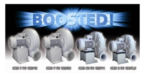
Über Frequenzumrichter werden die BOOSTED-Ventilatoren mit bis zu 135 Hz betrieben, dies entspricht Drehzahlen von annähernd 8.000 U/min. Aufgrund dieser enorm hohen Drehzahlen erreicht das stärkste Gerät dieser Baureihe Drücke von bis zu 21.000 Pa.
