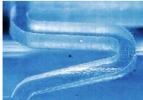
Abb.2: Bioresorbierbare Kunststoffe können trotz ihres niedrigen Schmelzpunktes und schlechter Absorption mit perfekten Kanten und Präzision geschnitten werden
