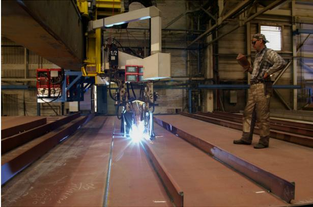
1: Automatisiert fügen die TimeTwin Digital-Systeme beidseitig die Versteifungsbleche auf die Grundfläche
