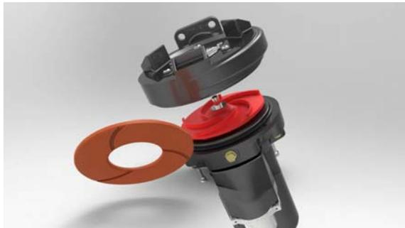
Das neue Laufrad (rot) aus glasfaserverstärktem Kunststoff ist deutlich beständiger im Kavitationsbetrieb. Die Schleißplatte (orange) schützt das Spiralgehäuse vor Verschleiß und ist leicht austauschbar.
