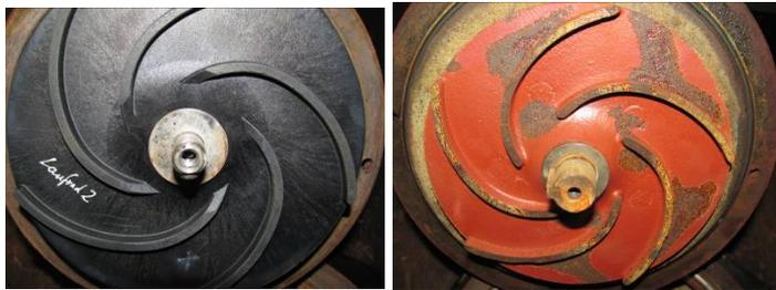
Nach 200 h im Kavitationsbetrieb zeigt das neue glasfaserverstärkte Kunststoff-Laufrad (links) seine Stärken. Das Grauguss-Laufrad (rechts) zeigt deutlichen Materialabtrag durch Kavitation.
