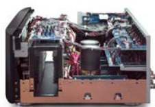
Seitenansicht der MM8077 mit Kühlungsschacht für optimale Wärmeableitung
