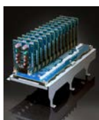
11.2-Kanal-Pre-Out-Treiberstufe mit 13x Hyper Dynamic Amplifier Module (HDMA) von Marantz
