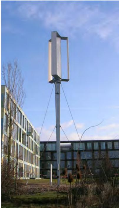
*Beispiel eines Vertikalsystems;
