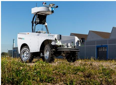
Das Roboterfahrzeug »Quanjo« liefert autonom Sensorsonden aus © Fraunhofer IOSB
