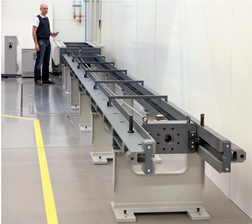
Bild: Die horizontale Prüfmaschine kann bis zu 40 m verlängert werden.
