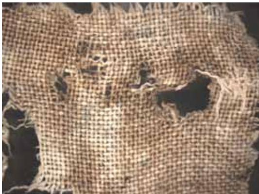
Die Prüfung der Bioabbaubarkeit kann unter standardisierten Laborbedingungen oder unter Freilandbedingungen (der Außentemperatur ausgesetzt) stattfinden. Außerdem können nach Bedarf der Versuchserde zusätzliche Mikroorganismen zugegeben werden, um den Verrottungsprozess kontrolliert zu beschleunigen. Die Untersuchungen geben Aufschluss über die Abbauraten und helfen Risiken auszuschließen. Hier ein Baumwollgewebe (zehnfach vergrößert) nach 10 Tagen im Erdreich. ©Hohenstein Institute
