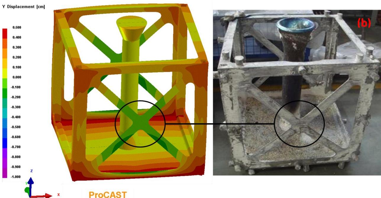
Image: La déformation observée sur la pièce finale au niveau du croisillon central (à droite) est prédite par les résultats de simulation fournis (à gauche).
