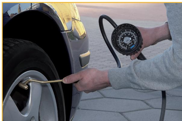
Tankklappe) vermerkt wird, belegen die Untersuchungen von verschiedenen Reifenherstellern und unabhängigen Instituten, dass mehr als die Hälfte der Autofahrer mit zu geringem Fülldruck unterwegs ist. Nur die Wenigsten wissen, dass sich durch diese Nachlässigkeit neben der Wirtschaftlichkeit des Reifens auch das Lenkverhalten,
