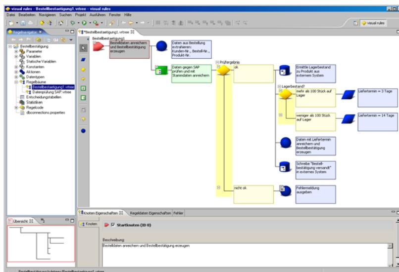
Aus einer Bestellung werden Daten extrahiert, diese werden gegen ein vorhandenes SAP-System geprüft und mit Stammdaten aus SAP angereichert. Aus einem externen System werden die
