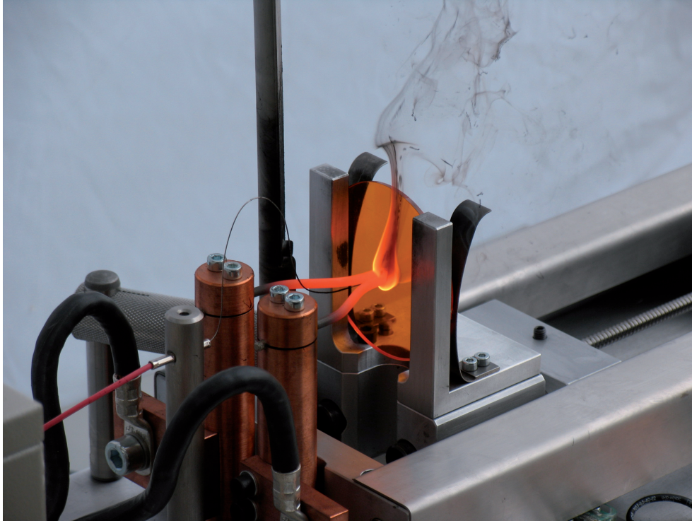
Halbautomatisches Prüfsystem von Zwick für die Glühdraht-Prüfung
