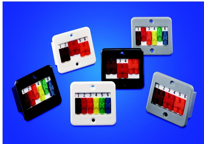
Bestückt mit verschiedenen farbigen Schiebern und nummerierten Polen erlauben diese Schalter einen schnellen Aufbau bzw. schnelles Einrichten und anpassen. Jeder Schieber hat einen tiefen „V“ Schlitz um jeden Bedienstift sicher aufzunehmen. Eine leichte Installation wird durch Lötkontakte oder 2,5mm x 0,5mm FASTON-Anschlüssen und Frontplattenbohrungen möglich gemacht.
