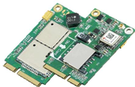
Le module embarqué combo cellulaire et GPS d'Advantech répond parfaitement aux besoins des applications eCall.
