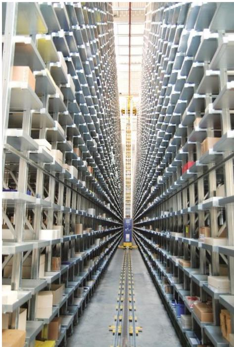
**Bildunterschrift:** Automatisiertes Kleinteilelager bei RÖHM
