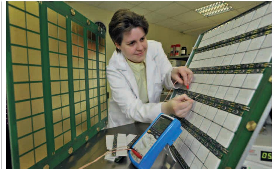
MESSUNG DER SPANNUNG an thermischen Transmittern.
