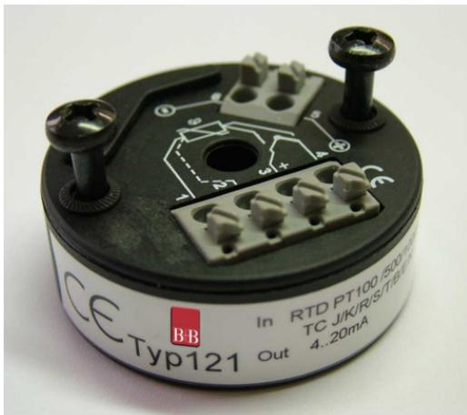
Der digitale Kopftransmitter Typ 121 ist ein programmierbarer Messumformer für verschiedene Widerstandssensoren und Thermoelemente. Er wandelt temperaturabhängige Messgrößen der Messwertempfänger hochgenau temperaturlinear in ein Standardstromsignal von 4...20 mA um und ist für den Einbau in B+B Temperaturfühler mit Anschlusskopf B vorgesehen.
