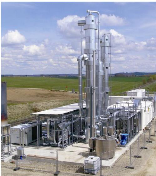
*Bild: HAASE BiogasVerstärker BGV 700 in Hahnennest*
