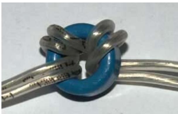
Obiges Bild zeigt den Aufbau des optionalen Störfilters für die Steuer Leitungen M/S bzw. M-GND. Beide Leitungen werden parallel etwa zweimal um den Kern gewickelt. Der Ringkern ist nicht im Lieferumfang enthalten.
