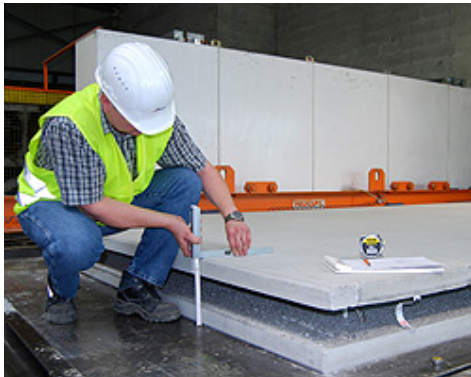
Im Fertigteilwerk Bad Dürkheim: Ralf Meyer, zuständig für das Qualitätsmanagement, bei der Vermessung eines Doppelwandelements
