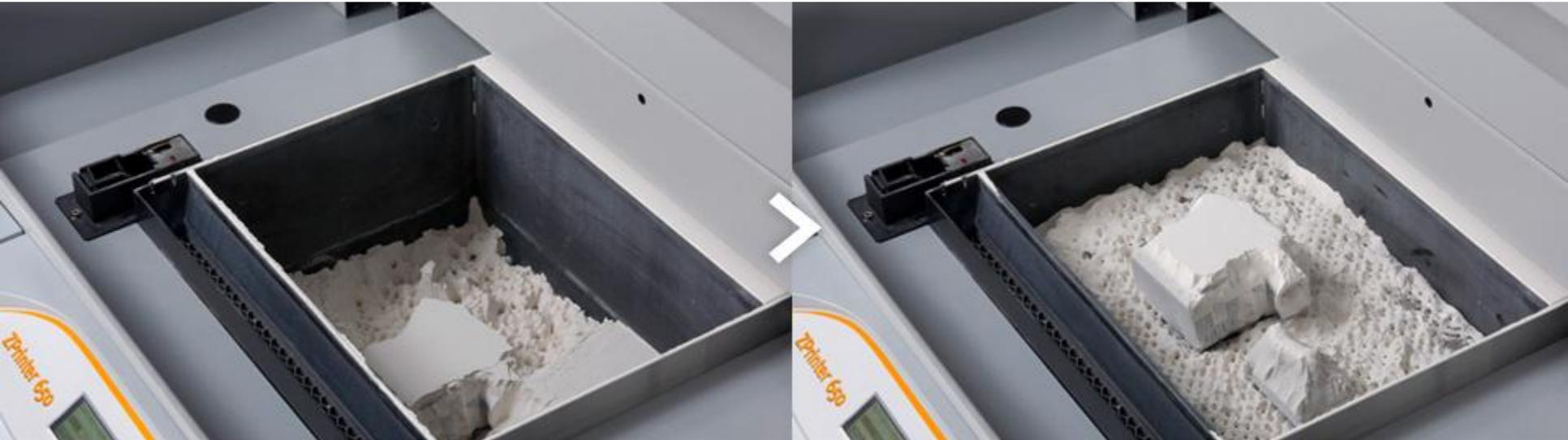
Nach dem Druck entfernt der ZPrinter 650 bis zu 80 % des Pulvers automatisch
