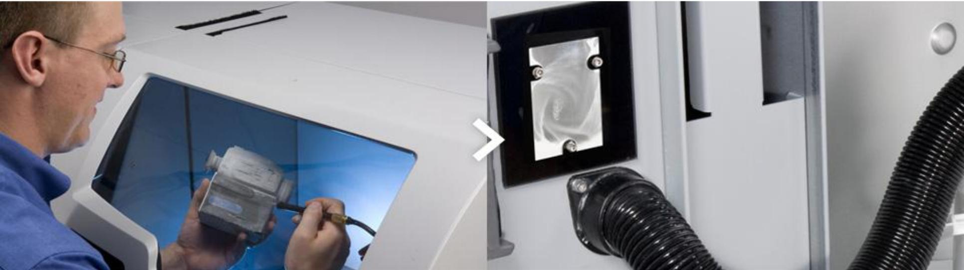
Pulverrückstände werden in einer geschlossenen Kammer mit Luft entfernt
