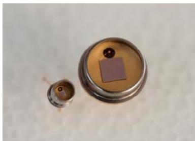
Abbildung: UV-Photodioden ([Link zur Bilddatenbank](#))
