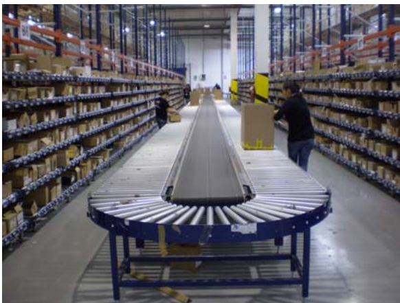
Bild 1: Ein Förderer gibt den Karton an den nächsten Bereich weiter, wenn der Auftrag noch nicht vollständig ist. So entfallen lange Arbeitswege.
