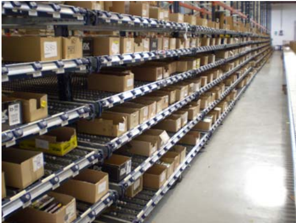
Bild 2: Pick-to-Light-Displays signalisieren Entnahmestellen und -mengen für den laufenden Kommissioniervorgang im Pickbereich.
