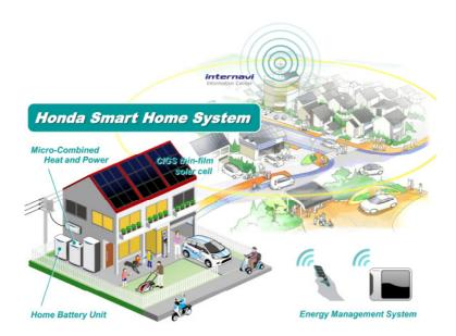
Das Honda Smart Home System steuert die Erzeugung und den Verbrauch von Elektrizität und Wärme innerhalb des Hauses und stellt auch im Katastrophenfall die autarke Versorgung mit Strom und Wärme sicher.
