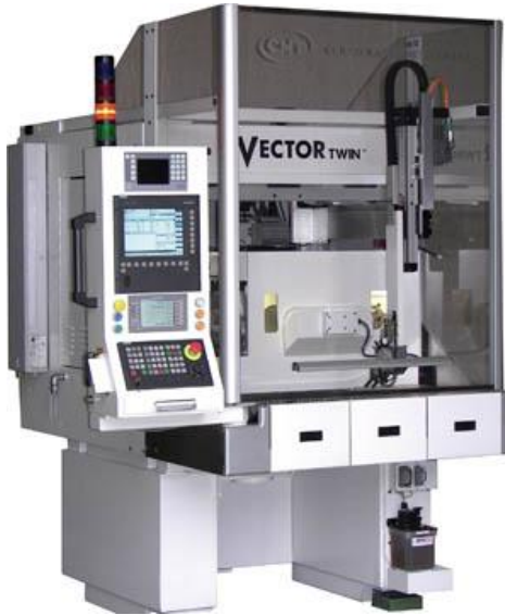
Bild Nr. 01-01 TT_CMT-VectorTwin.jpg Mit der neuen Doppelspindel- Rundschleifmaschine Vector Twin Mark IV des englischen Herstellers Curtis Machine Tools Ltd (CMT) präsentiert die TECNO.team GmbH auf der EMO die bewährte Technologie mit 40 % größerem Verfahrweg.
