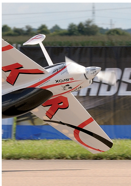
Das Modellflugzeug, eine PM42 3, in das die Luftkühlung eingebaut wurde. Es wiegt 19 kg und hat eine Spannweite von 3,1 Metern.
