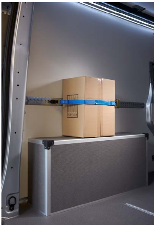
Abbildung 3 VANYCARE®-Komplettausstattung incl. Radkastenverkleidung und Zurrschienen
