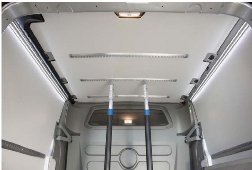
Abbildung 2 VANYCARE®-Komplettausstattung incl. Dachhimmelverkleidung, Sperrstangen und Zurrschienen
