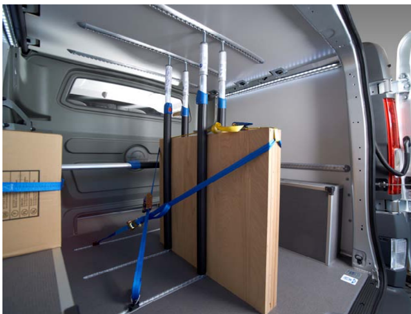
Abbildung 4 VANYCARE®-Komplettausstattung incl. Ladungssicherungssystem mit Sperrstange, Zurrschienen und Gurten
