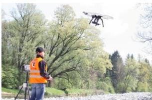
*Mit dem Aibot X6 generieren Vermesser innerhalb kurzer Zeit hoch präzise, umfangreiche Daten, die vielfältig weiterverarbeitet werden können. Hier wird ein Flussabschnitt für ein Renaturierungsprojekt vermessen.
