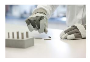
Bei Schutzhandschuhen wird u.a. die Beeinträchtigung der Feinmotorik getestet. Dazu müssen Metallstifte mit unterschiedlichen Durchmessern sowohl mit der rechten als auch mit der linken Hand gegriffen werden. ©Hohenstein Institute
