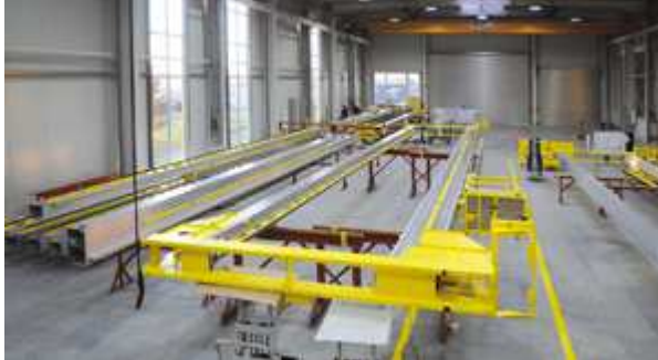
Innenansicht der neuen Fertigungshalle mit Blick auf zwei der insgesamt zehn 16m-RGBs für Fa. Krämer Pferdesport, Hockenheim (Photo: psb intralogistics GmbH)
