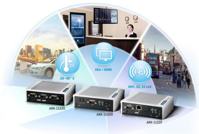
Beispielsweise unterstützt der ARK-1122H unabhängige VGA/HDMI-Dual-Displays für Digital-Signage-Anwendungen. Der ARK-1122C unterstützt vier COM-Ports, was ideal für die Fabrik-/Maschinenautomatisierung ist. Und der ARK-1122F unterstützt Dual-GbE-LANs und WiFi/3G für die Internet-Datenübertragung und richtet sich speziell an Thin-Client-Anwendungen.
