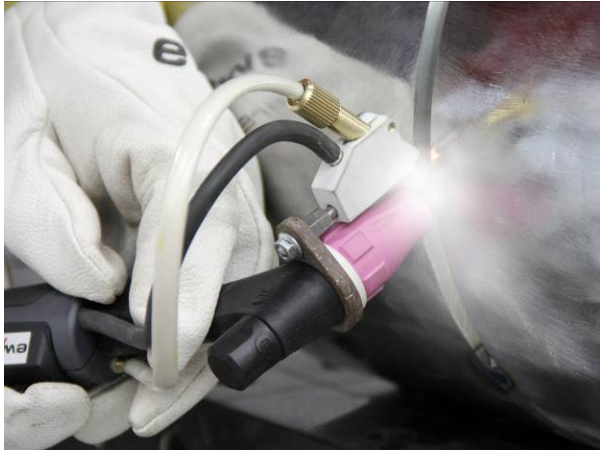
Abb. 10: tigSpeed erlaubt das einfache und sichere Wurzelschweißen von Rohren in Zwangspositionen
