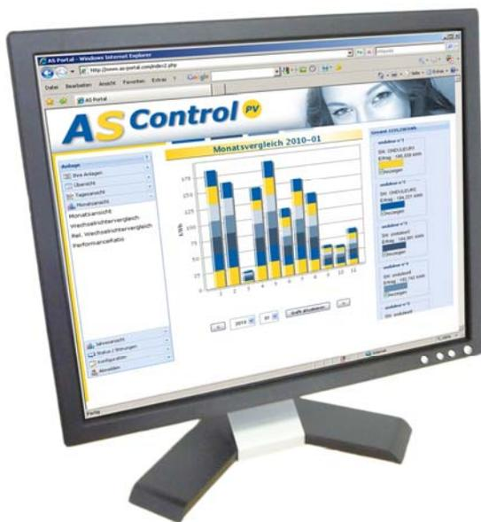
Die Status- und Störungsmeldungen der Wechselrichter werden durch das **PV-Interface** direkt ausgelesen und ausgewertet. Der Nutzer kann weltweit in Echtzeit auf die Ertrags- und Anlagendaten zugreifen und eine genaue Eingrenzung der eventuellen Anlagenstörung an jedem internetfähigen Rechner unter [www.as-portal.com](http://www.as-portal.com) vornehmen.
