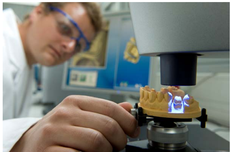
Laserscan für ein digitales Zahnmodell (© K. Dobberke für Fraunhofer ISC)
