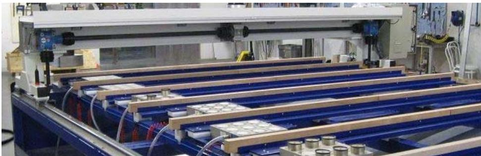
**Foto 1: Fräsmaschine mit Flip-Pod-Spannplatten**
