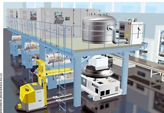
In direkter Nachbarschaft zur Siliziumfabrik steht die Ingot-Fertigung. Hier wird das Polysilizium geschmolzen, kristallisiert und die dann entstandenen Ingots in Säulen gesägt. Die Herstellungskosten für diese Siliziumsäulen betragen (ohne den Rohstoff Silizium) 20,71 Euro je Kilogramm, das sind 0,14 Euro je Watt im Modul.
