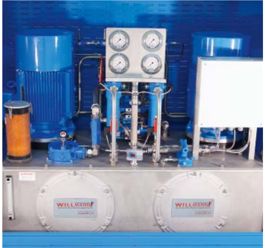
» Die Brücke wird innerhalb von 120 Sekunden um 2,7 Meter angehoben – die Kraft dafür kommt von zwei Motoreinheiten. » The bridge is raised 2.7 metres in just 120 seconds – with the necessary power supplied by two motor units.
