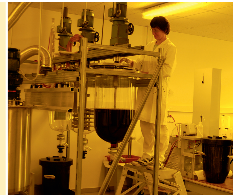
Herstellung eines kommerziellen Fotoresists unter Gelblicht
