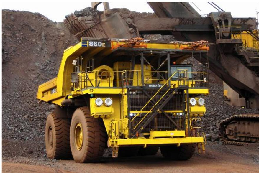
Die neuen Siemens-Antriebssysteme werden erstmals bei dem Truck 860E-1K von Komatsu eingesetzt.
