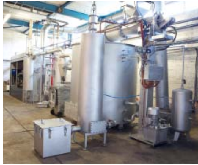
» Im Holzvergaser (links) wird das Holzgas produziert. Der Gasmotor (rechts) erzeugt den elektrischen Strom. » The wood gas is produced in the wood gasifier (left). The gas motor (right) generates the electrical power.
