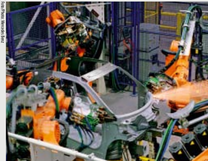
» Industrieroboter sind mittlerweile fester Bestandteil in der Automobilfertigung. » Nowadays, industrial robots are an established element of car manufacturing.
