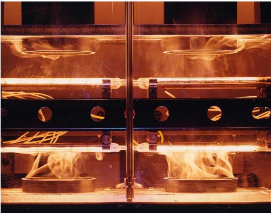
Infrarot-Strahler helfen glasfaserverstärkte Druckbehälter zu verschweißen.
