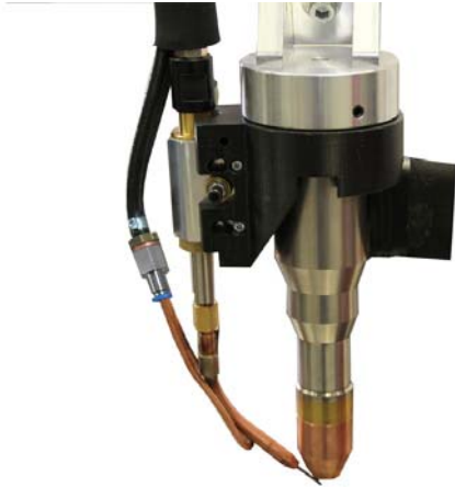
Abb. 2: „forceTig“-Brenner mit Heißdrahtzuführung
