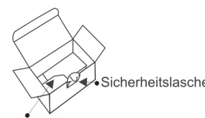
Automatikboden mit Sicherheitsarretierung
