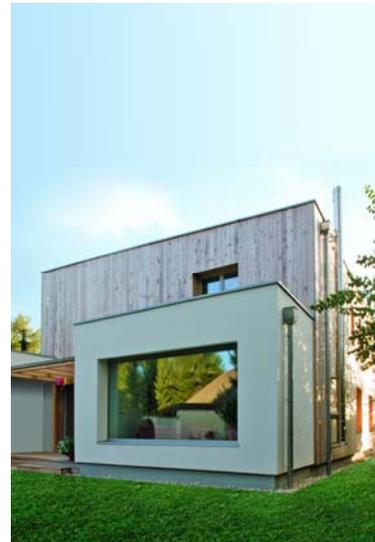
Als alleiniger Wärmeerzeuger übernimmt die Sole-Wasser-Wärmepumpe nicht nur die Beheizung des Einfamilienhauses, sondern auch die Warmwasserbereitung. Über zwei Erdsonden mit einer Länge von 99 Metern wird dauerhaft Wärme aus dem Erdreich gefördert.
