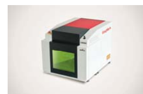
Abb. 14: Der neue kompakte EasyMark erleichtert das Beschriften auch sperriger Werkstücke sowohl als Stand-Alone System oder integriert in Fertigungsstraßen
