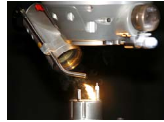
Abb. 11: Die Lichtleiter Drehoptik (LLDROP): Faserlaser-Bearbeitungskopf für das Punkt-, Naht- und Segmentschweißen, ideal für Automationslösungen mit hohen Stückzahlen bei vereinfachtem Werkstückhandling
