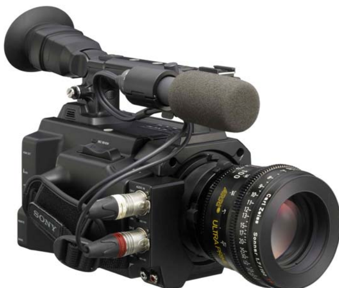
Bild 1: Mit dem PL-Mount-Adapter der PMW-F3 können Anwender sowohl PL- als auch Zoom-Objektive zahlreicher Hersteller wie Cooke, Arri, Fujinon und Zeiss verwenden.
