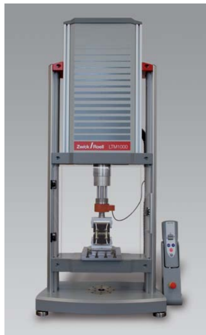
Bild 1: Material-Prüfmaschine mit Linearantrieb LTM1000
