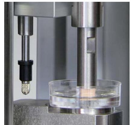
Bild 3: Druckversuch an Knochenersatzmaterial
