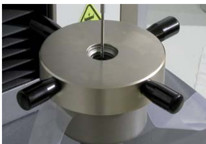
Bild 1: Folienhalterung für Durchstechkraftmessung
