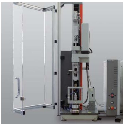
Bild 2: Material-Prüfmaschine zwicki-Line mit integriertem Torsionsantrieb für die automatische Prüfung von Medikamenten-Pens
