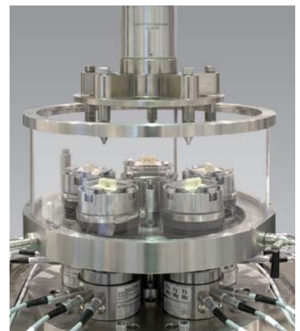
Bild 4: Prüfvorrichtung für Zahnimplantate (Zahnklinik Universität Ulm)
