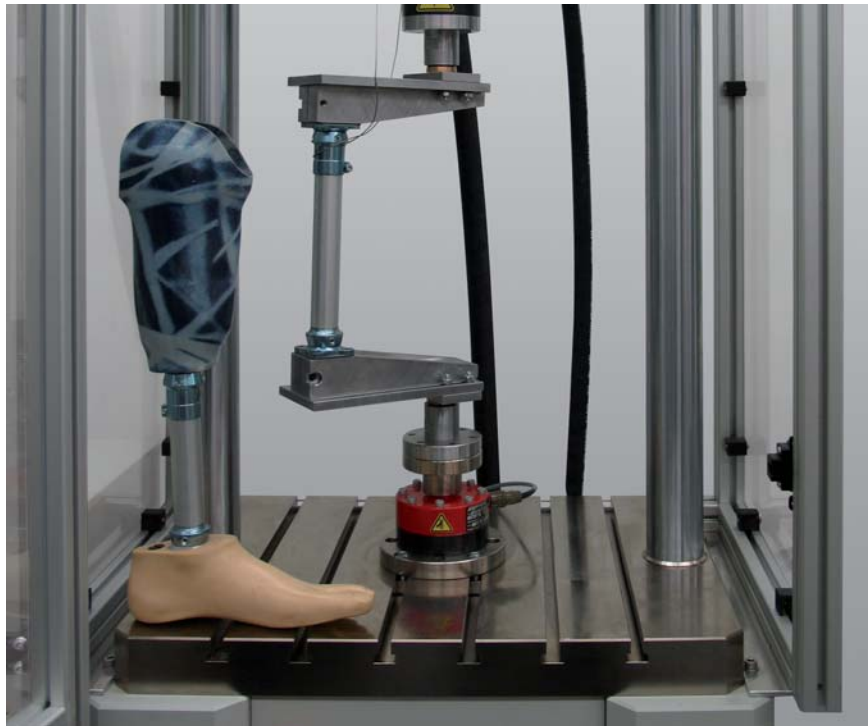
Bild 1: Prüfvorrichtung für Unterschenkel-Prothesen
