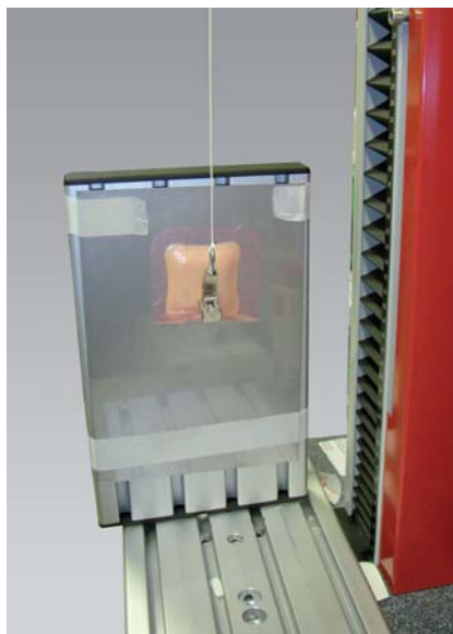
Bild 2: Ermittlung von Adhäsionskräften von Wundauflagen
