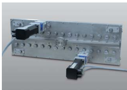
Bild 2: Prüfvorrichtung für Stents
