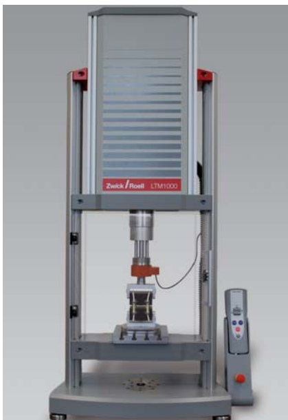
Bild 1: LTM1000 mit Wirbelsäulenimplantat
