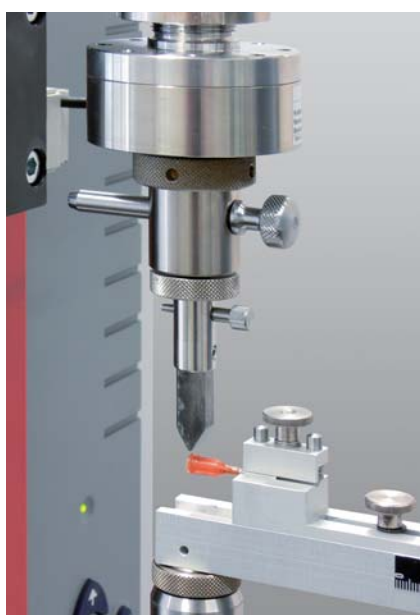
Bild 1: 2-Punkt-Biegevorrichtung für die Prüfung von Injektionsnadeln
