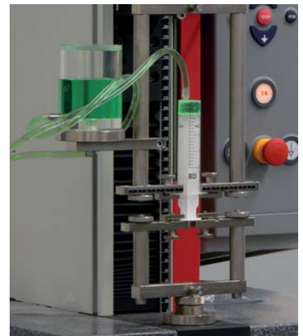
Bild 4: Bestimmung der Kolbenbewegungskraft an Spritzen
