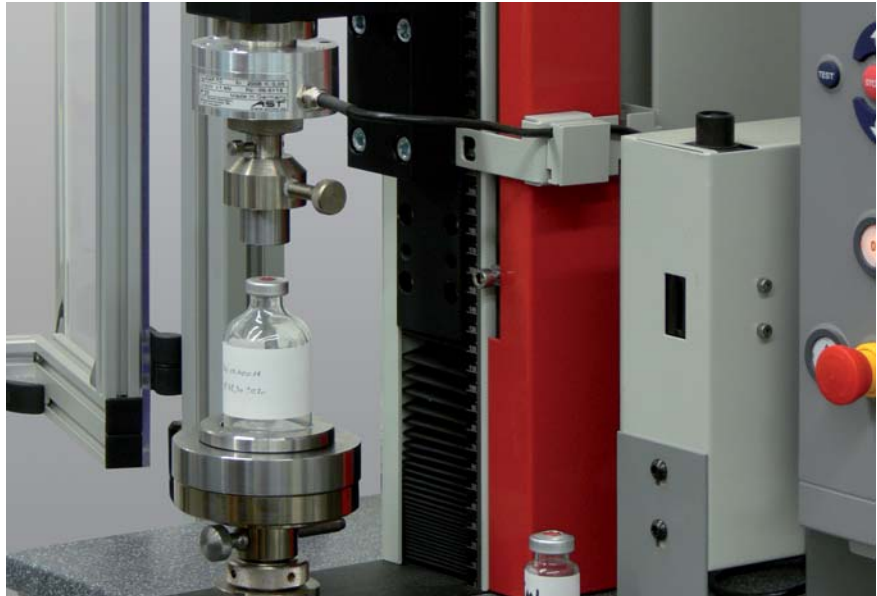
Bild 1: Material-Prüfmaschine zwicki-Line mit Vorrichtung zur zerstörungsfreien Prüfung von Verschlusskappen
