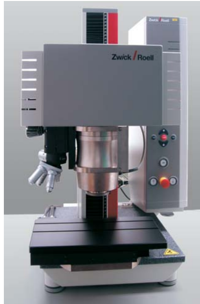
Bild 1: Vollautomatische universelle Härteprüfmaschine Zwick/ZHU2.5/Z2.5 mit motorischer Verschiebeeinheit
