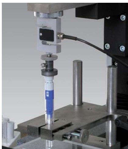
Bild 1: Ausdrückvorrichtung für die Prüfung an Insulin-Pens
