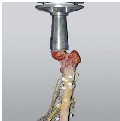
Bild 1: Femur mit applizierten Dehnmessstreifen (DMS)
