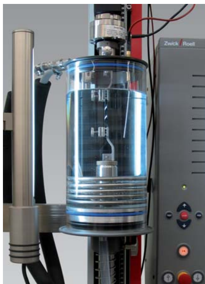
Bild 1: Mediumbehälter mit Temperiereinheit
