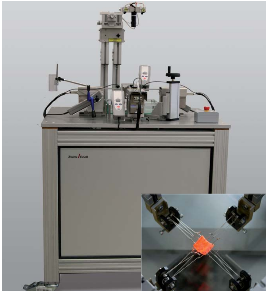
Bild 1: Biaxiale Material-Prüfmaschine mediX0.1 mit integriertem laserXtens Kleines Bild: Probenhalter für biaxiale Versuche an Biomaterialien
