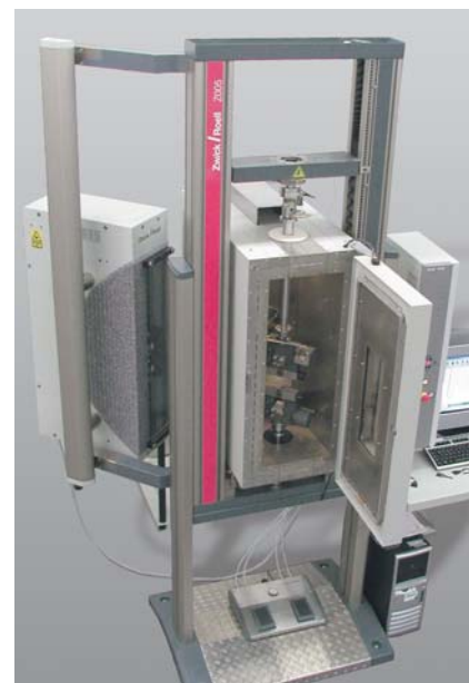
Bild 3: Temperierkammer integriert in eine Material-Prüfmaschine
