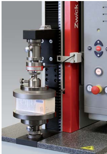
Bild 2: Druckversuch an Kartonverpackung
