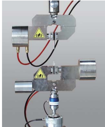
Bild 2: Prüfung von Luer-Lock-Verbindungen
