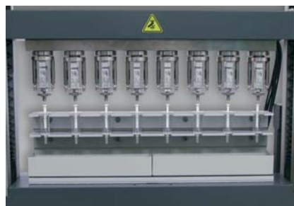
Bild 3: Vorrichtung für die gleichzeitige Prüfung von bis zu 8 Spritzen
