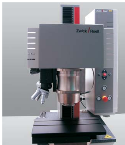
Bild 2: Vollautomatische universelle Härteprüfmaschine Zwick/ZHU2.5/Z2.5 mit motorischer Verschiebeeinheit
