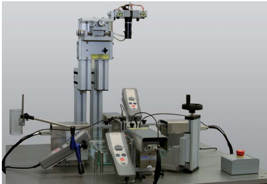
Bild 1: Biaxiale Material-Prüfmaschine mediX0.1 mit laserXtens
