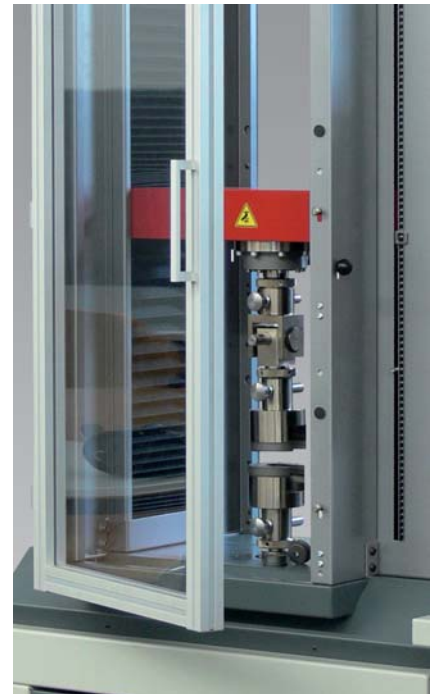
Bild 2: ProLine Z050TN mit CE-konformer Schutzscheibe
