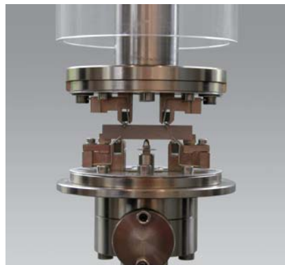
Bild 1: 4-Punkt-Biege Probenhalterung für Zahnkeramiken
