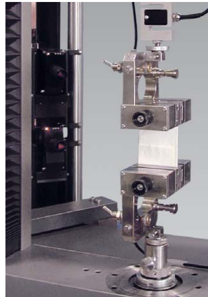
Bild 5: Zugprüfung an Vliesen mit optischem Längenänderungsaufnehmer
