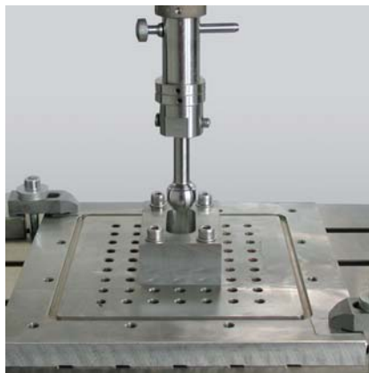
Bild 2: Torsionsprüfung an künstlichen Hüftgelenken
