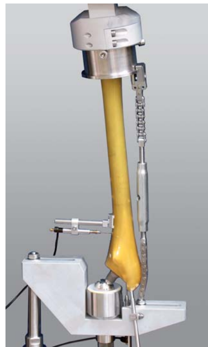
Bild 2: Probenhalter für Versuche an Endoprothesen
