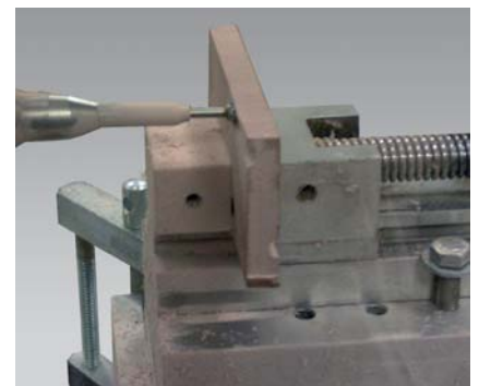
Bild 2: Eindringversuch eines Knochenbohrers
