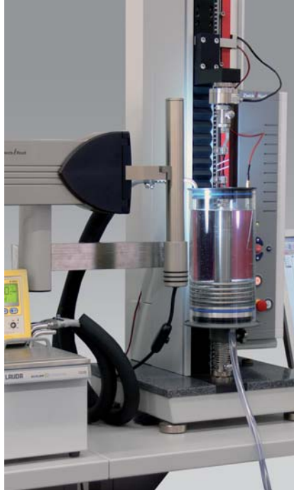
Bild 1: zwicki-Line mit temperiertem Mediumbehälter und videoXtens (Behälter für Probenwechsel abgesenkt)
