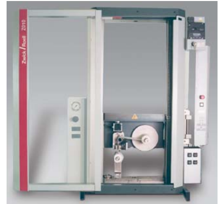
Bild 3: Abrollvorrichtung für Mullbinden
