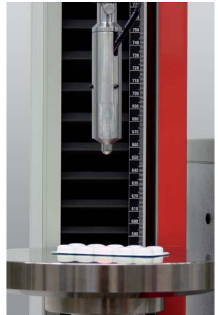
Bild 2: Prüfvorrichtung mit Laserpositionierung für Ausdrückversuch
