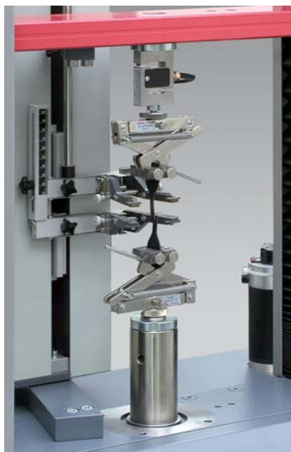
Bild 1: Zugversuch an Gummi-Rohmaterial
