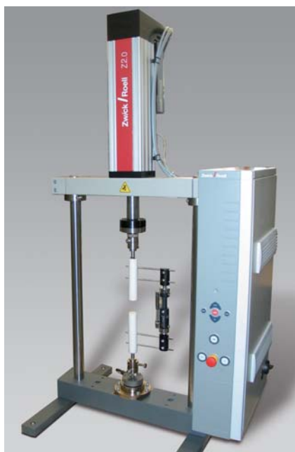
Bild 2: Einzelprüfzylinder für Prüfung an externem Fixateur
