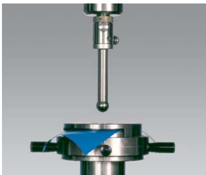
Bild 2: Prüfung der Berstfestigkeit
